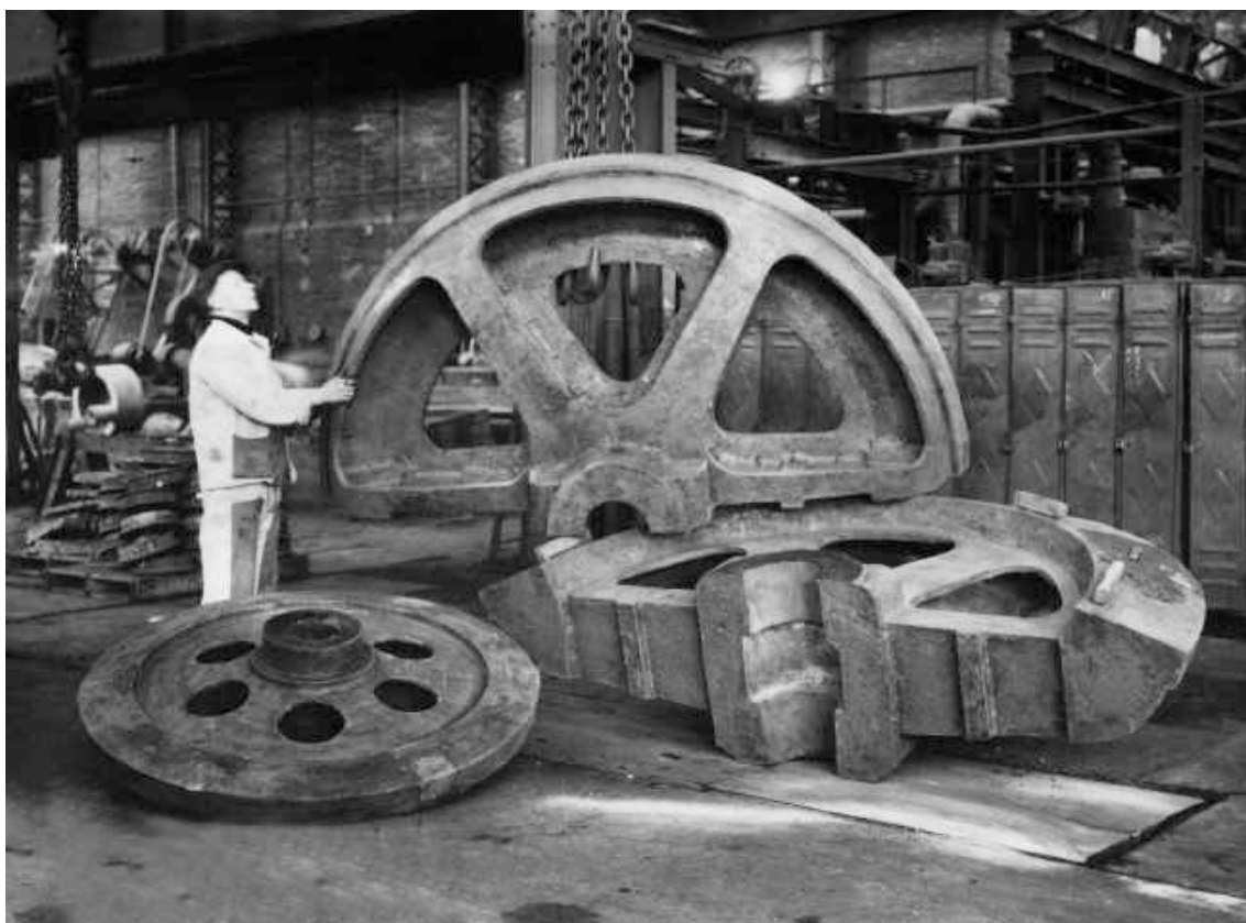
Modèles pour engrenage conique en deux parties.
